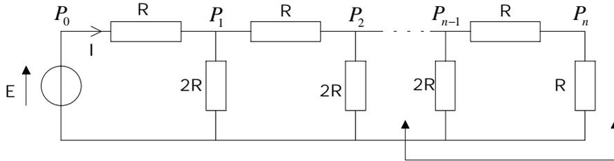
Déterminons la résistance équivalente de la dernière "cellule", soit  $R_e$
